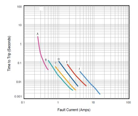
A-PBT0805-005 B-PBT0805-010 C-PBT0805-016 D-PBT0805-020 E-PBT0805-035 F-PBT0805-050
